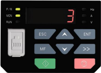
图 4-10 功能码二级显示图（3 为 b0-00 的内容）
