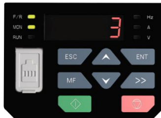
图 4-10 功能码二级显示图（3 为 b0-00 的内容）
