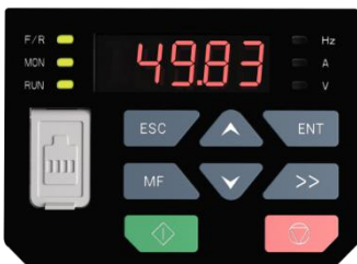
图 4-6 功能码参数设置状态图（设置 b0-02=49.83Hz）
