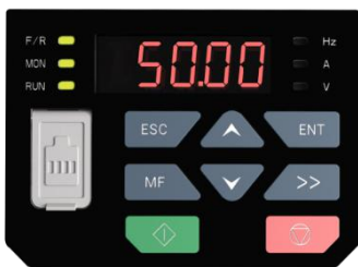
图 4-3 运行参数显示状态图（显示运行频率 50Hz）
